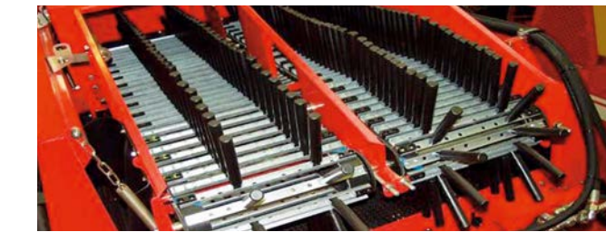
Type UB: beste reinigingsresultaten op gronden met veel kluiten en met weinig stenen
