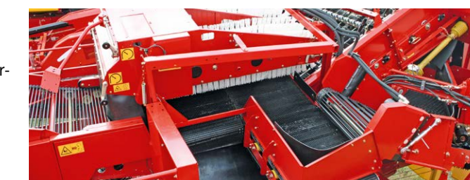
Type SB: beste reinigingsresultaten op gronden met veel stenen dankzij de innovatieve kinetische stenenscheider
