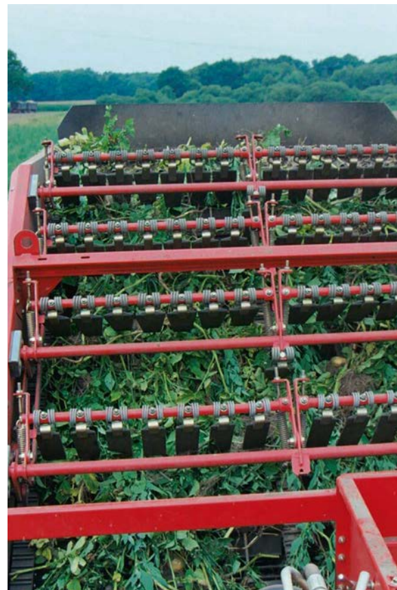
Optimale productvriendelijkheid: Loofband met zachte PU-meenemers (afstanden naar keuze 200 mm, 280 mm)
